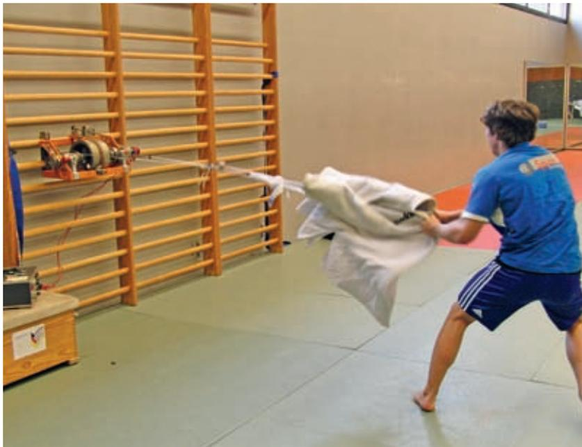
Erfassung von Anrisskraft, Hubkraft und Anrissgeschwindigkeit an einer Seilzugmaschine.
