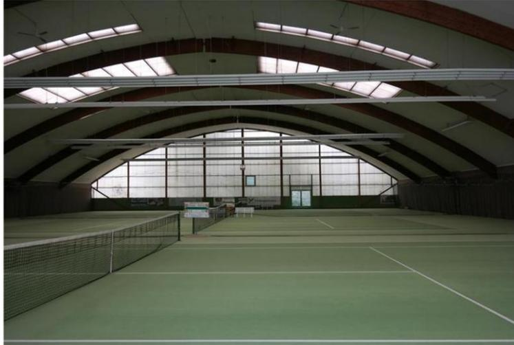
Tennishalle mit drei Feldern und parallel zur Seitenlinie montierten Leuchtstoffröhren.
