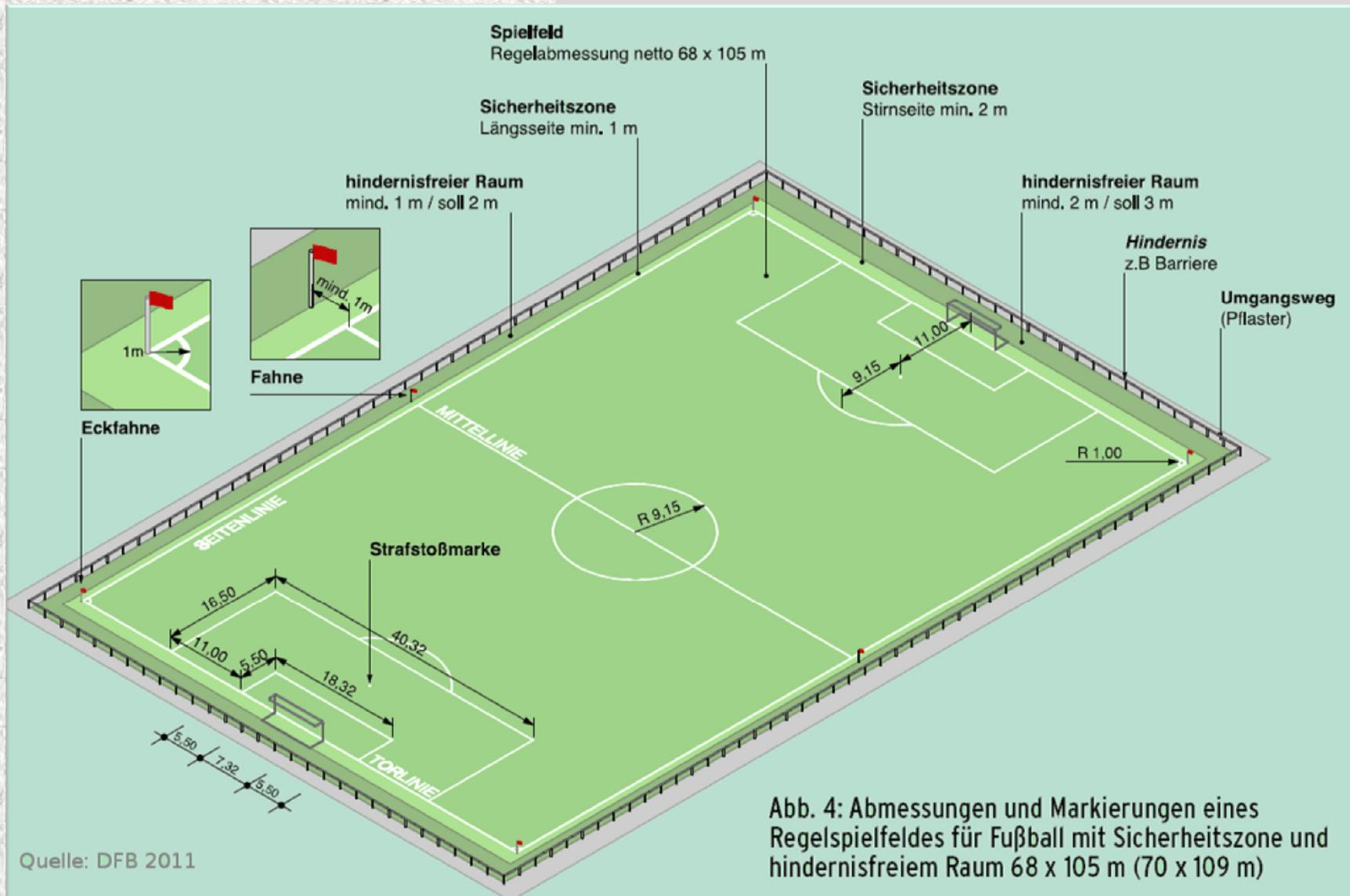
Abb. 4: Abmessungen und Markierungen eines Regelspielfeldes für Fußball mit Sicherheitszone und hindernisfreiem Raum 68 x 105 m (70 x 109 m)
